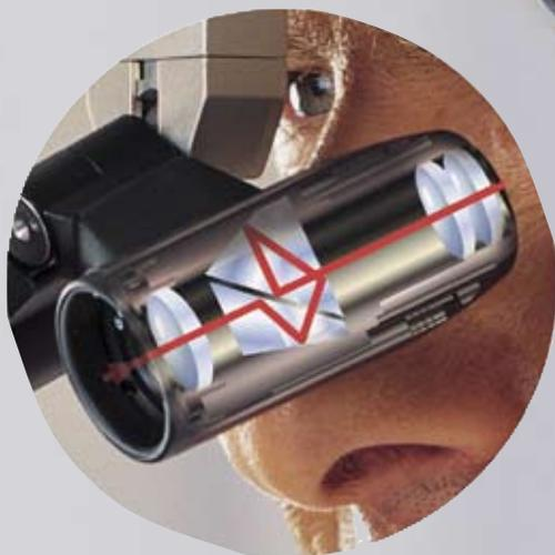
Призмные лупы ZEISS базируются на принципе системы Кеплера. Это система призмных луп состоящая из объектива, окуляра и оборачивающей системы. Синтез блестящей оптики и компактной конструкции обеспечивает прекрасное качество изображения при небольшом весе.
