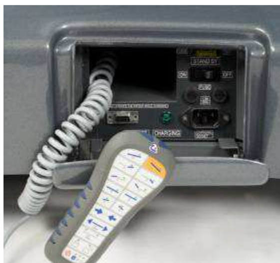
Рис. 4 Вспомогательный пульт управления в контрольной панели
