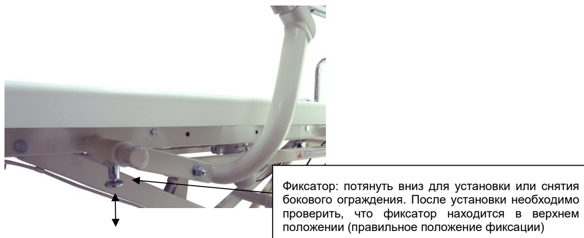
Рис. 9. Прикрепление бокового ограждения под верхним каркасом
