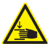
Рис. 23. Предупреждение о риске раздавливания и защемления
