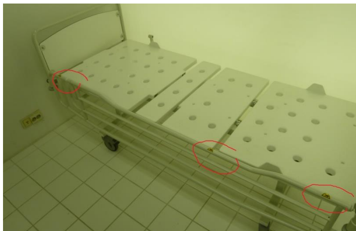
Рис. 6. Места возможного защемления рук/пальцев при регулировании ложа, спинной и коленной секции.
