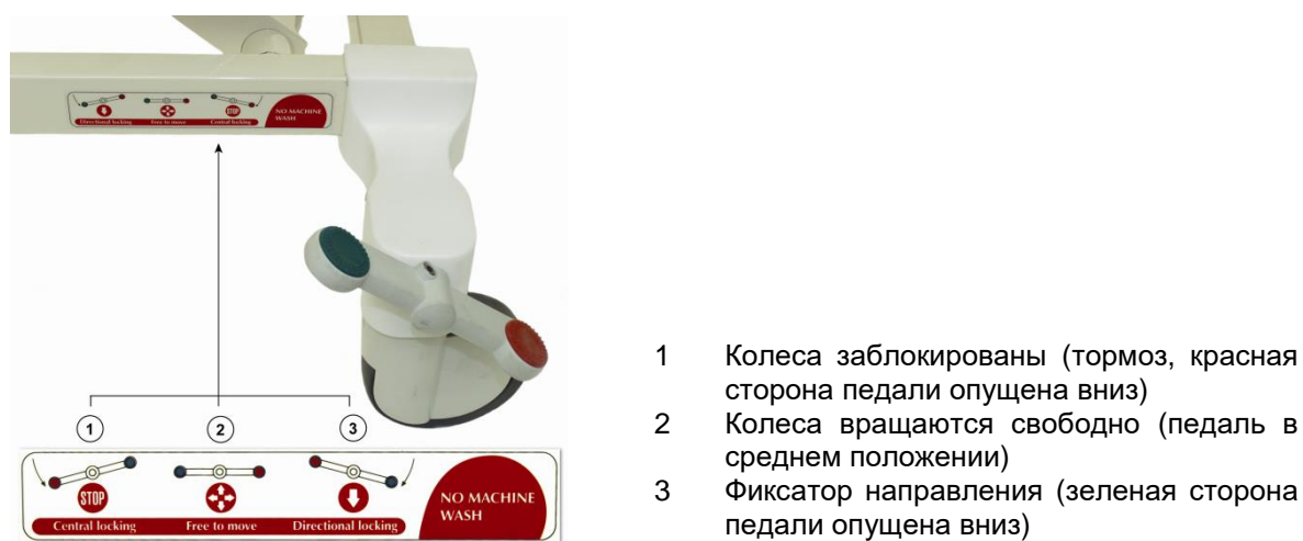
Рис. 3 Фиксация колес с центральным тормозом
