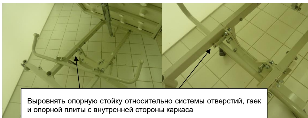
Рис. 11. Установка передней опорной стойки (быстроразъемная система)
