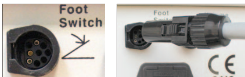
Рис. 38. Гнездо для подключения двойной ножной педали «Foot Switch» (слева) Специальный штекер шнура двойной ножной педали (справа)
