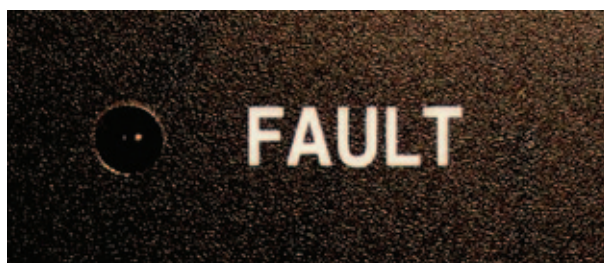
Рис. 19 Индикатор ошибки (FAULT) в исправном аппарате не загорается
