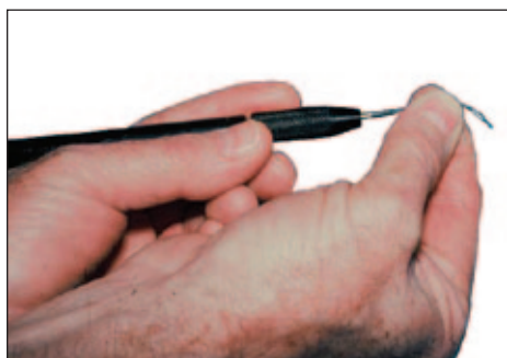
Рис. 45. Фиксация электрода в наконечнике
